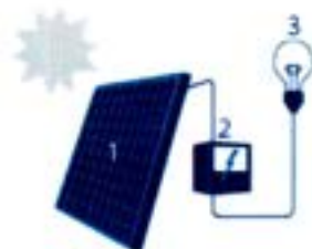
1. Zonnepaneel | 2. Omvormer | 3. Elektrische installatie
